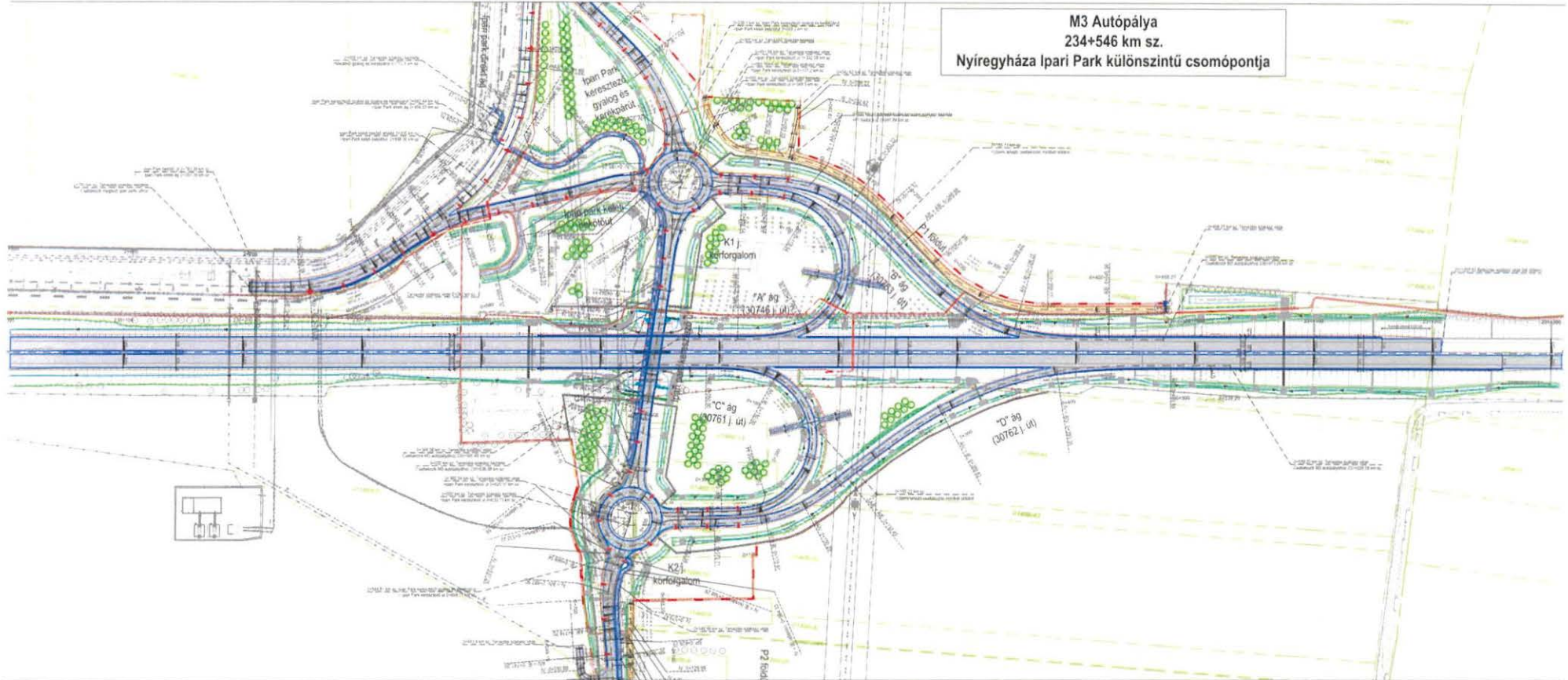
Nyíregyháza Ipari Park bővítése – M3 autópálya új külön szintű csomópont – Általános helyszínrajz - részlet Tervező: CIVIS KOMPLEX MÉRNÖK Kft. (4034 Debrecen, Nagybánya u. 17.)
