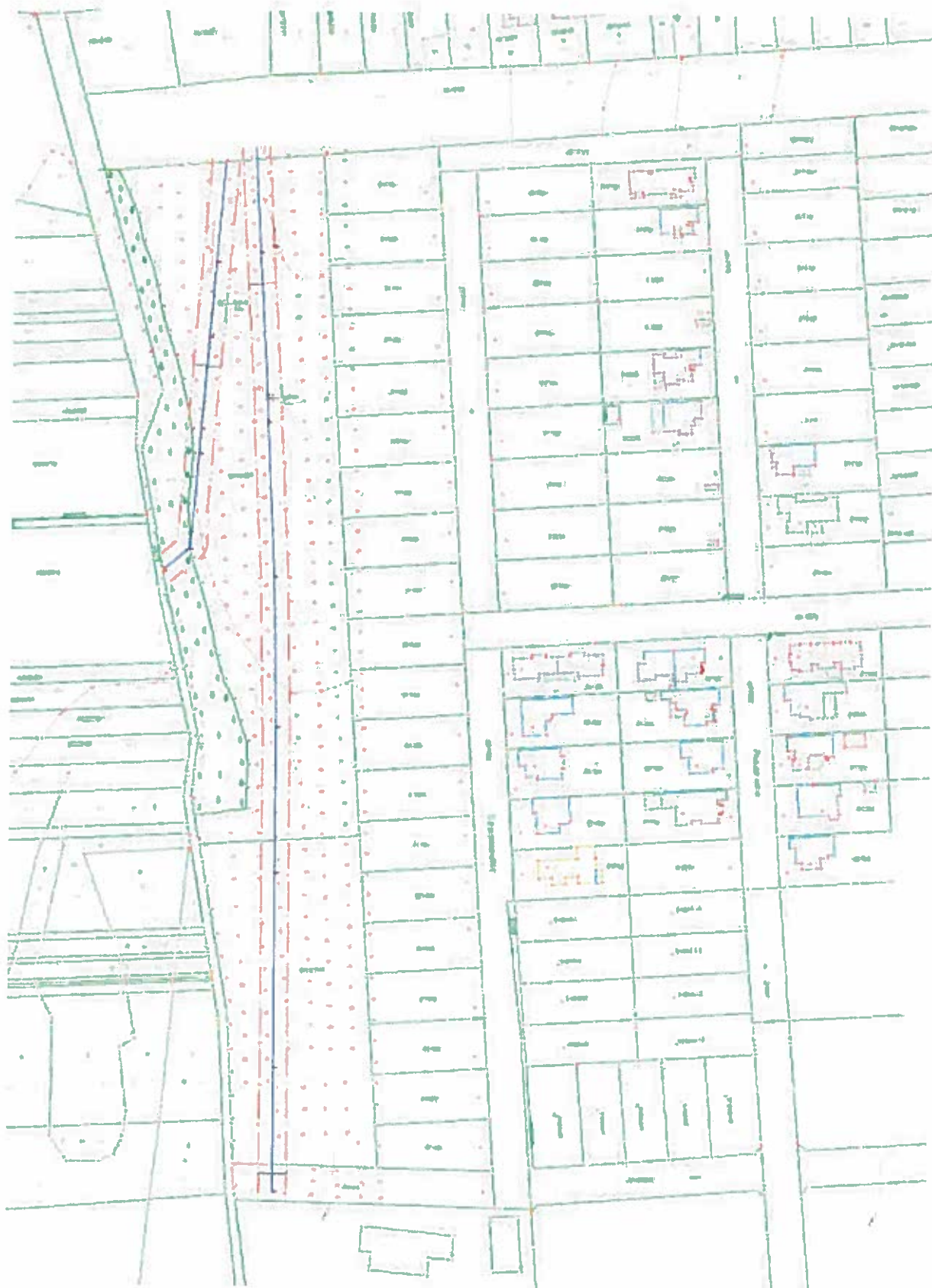
A geodéziai felmérés szerint a 2 db 600-as vízvezeték és a már kialakított belterületi építési telkek viszonya
