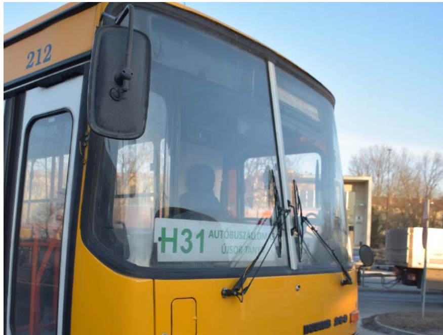
29. kép: Tábla alapú homlokfali utastájékoztató egy Ikarus 263-as autóbuszon
